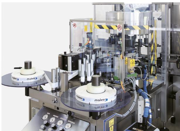
aguas y los refrescos, pero con exigencias de producción entre las 6.000 y las 16.000 b/h es la nueva serie de etiquetadoras **MAKLINE Roll Feed**: ejes motorizados y motores brushless reducen al mínimo los costes manteniendo una calidad rigurosa de etiquetado.
